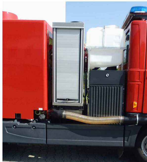
Aufbewahrungsbox für Zusatzgeräte und Vorratsbehälter für Vorsprühmittel
