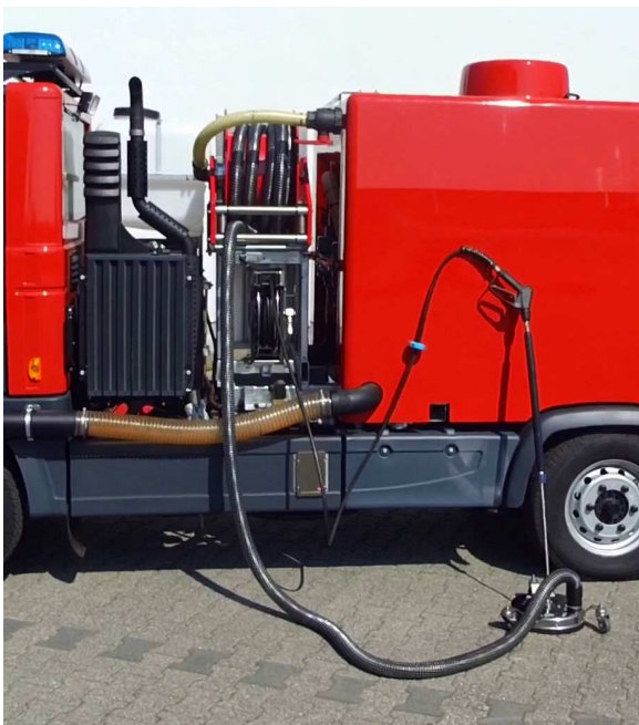
Handlanzensystem ausziehbar, 10m Aktionsradius
